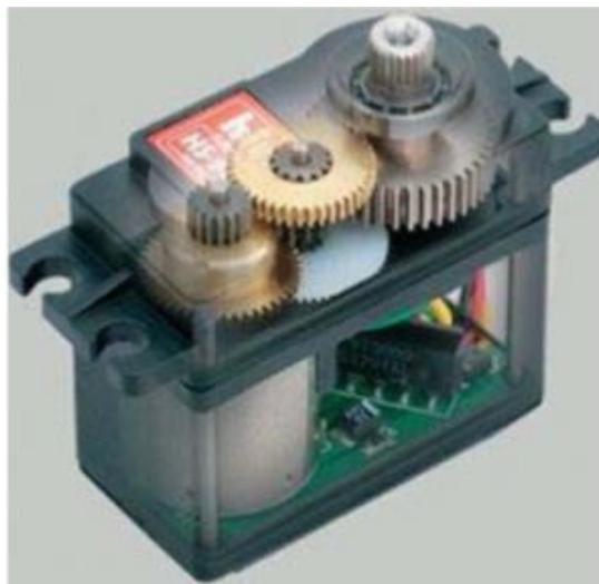
Figura 3.5 – Estrutura de um servo motor (UNESP, 2013).
