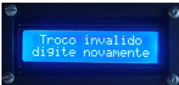
Figura 4.6 – Tela exibida quando se digita um troco maior do que o montante da máquina.
