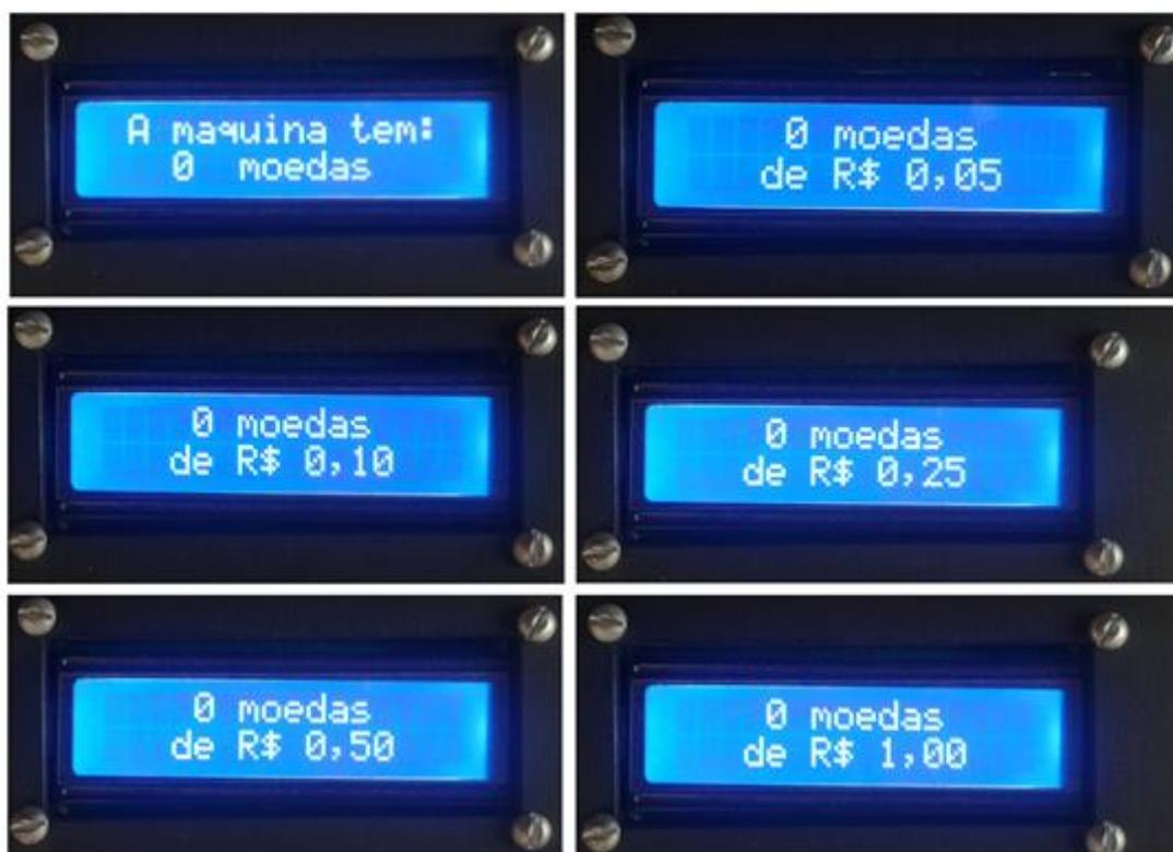
Figura 4.3 – Quantidade de moedas geral e específica na máquina.
