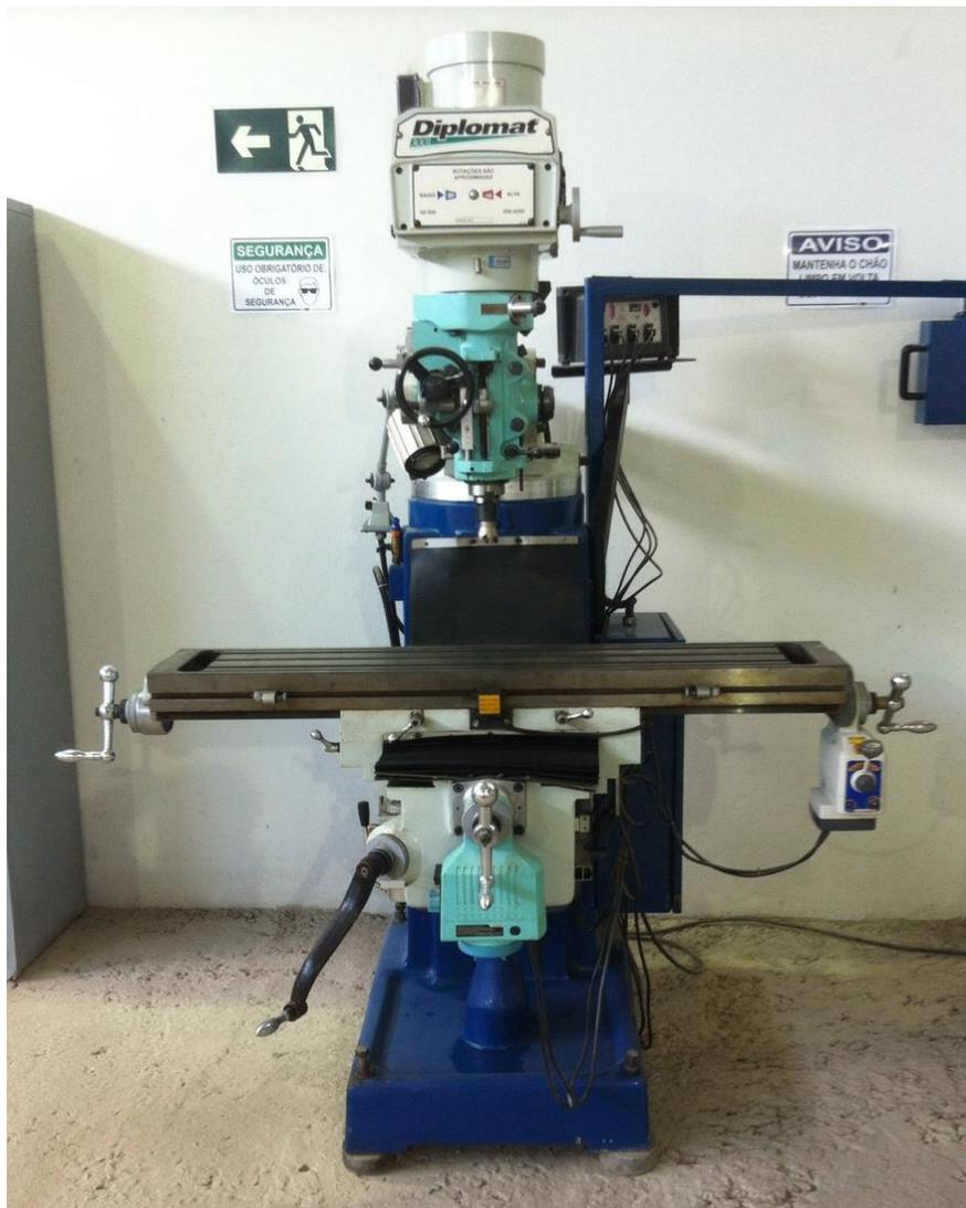
Figura 3.7: Fresadora manual Diplomat, localizada no galpão de mecânica.
