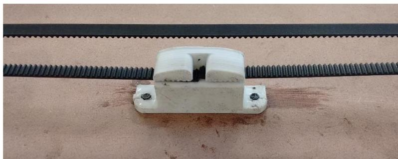
Figura 3.12: Acoplamento de correia.
