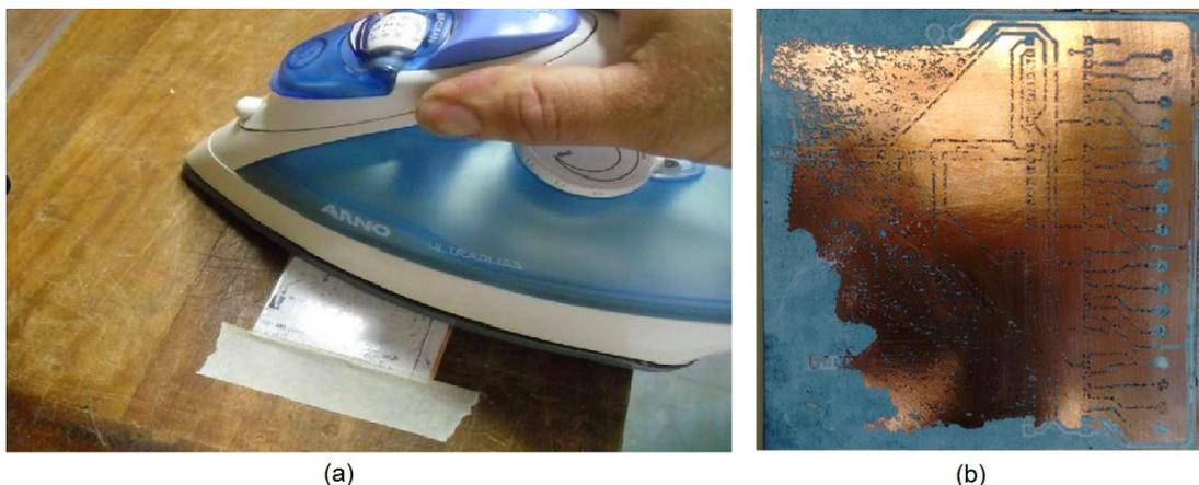
Figura 1.1(a): Método (HOLLOWSTATE, 2015) e 1.1(b):Resultado da transferência de calor.
