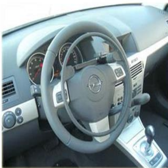
Figura 1: Acelerador e freio em forma de aro sobre o volante. Fonte: Google/imagens
