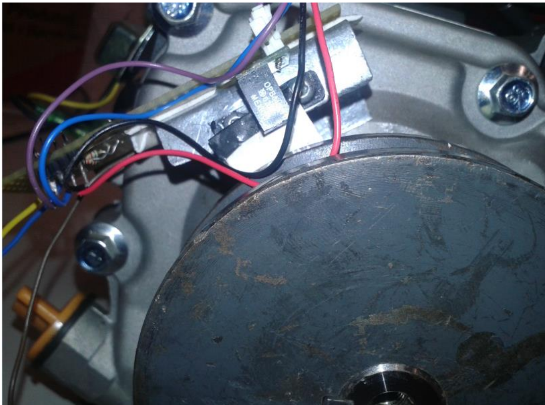
Figura 12: Sensor preso por suporte próximo ao eixo do motor.
