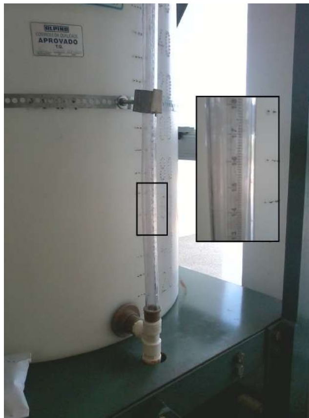
Figura 2.10: Visor de nível construído a partir de materiais de baixo custo.
