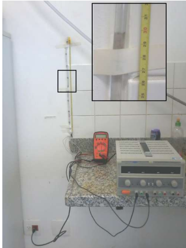
Figura 2.4: Plataforma de testes do sensor de pressão
