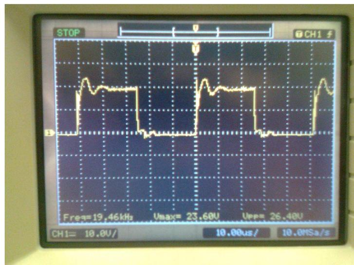
**Fig. 5.10** - Atenuação de ruído com a utilização de um circuito *snubber*.
