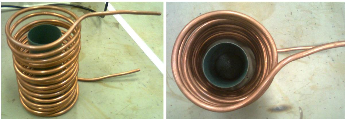
**Fig. 3.5** – Cadinho auxiliar com bobina de aquecimento.
