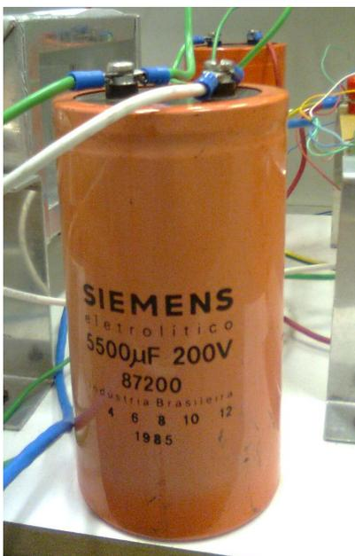
Fig. 4.12 - Capacitor de retificação.
