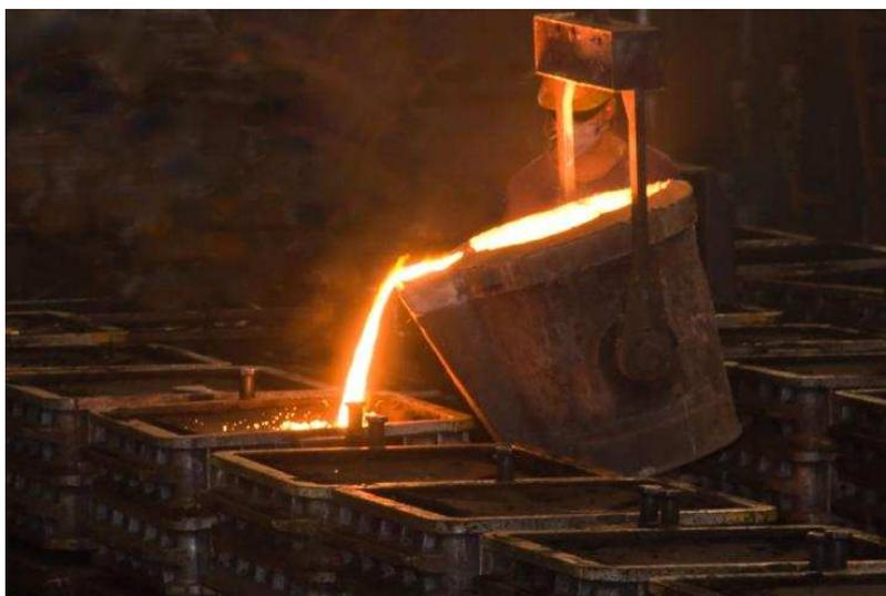
**Fig. 2.1** - Fundição com molde de areia.
