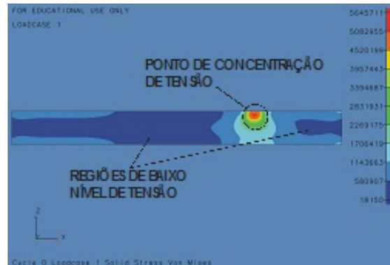
Figura 2.2: Plano de tensões de uma placa engastada nas quatro extremidades (longitudinal).
