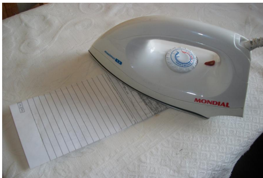
Figura 5.10: Passando o desenho para a placa
