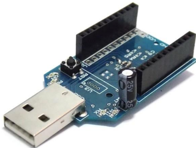
Figura 5.4: Placa COM-USB BEE.
