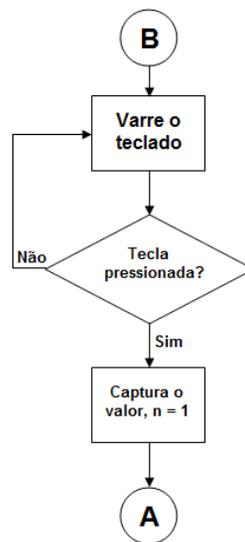
Figura 3.4 Fluxograma sub-rotina "B"
