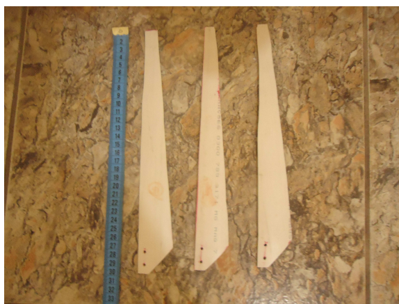
Figura 8.3: Pás do protótipo
