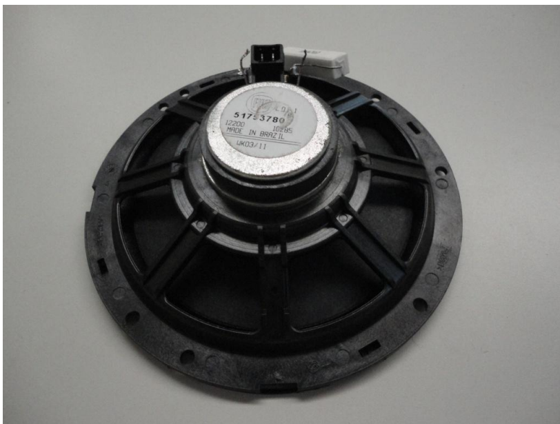
Figura 3.4: Alto Falante ASK, de 6 polegadas. Imagem Real do transdutor.
