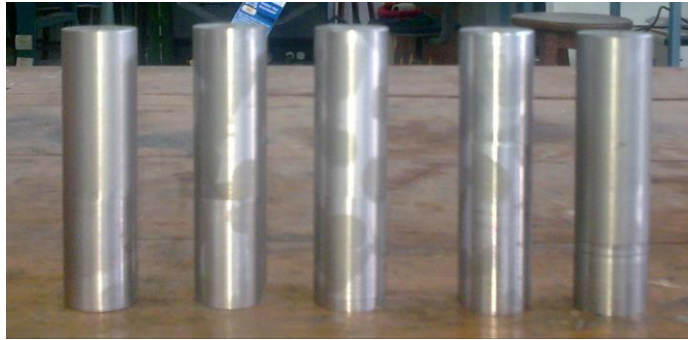
Figura 4.6 – Modelo dos corpos de provas – pré-usinagem. Fonte: Autor do estudo (2014).
