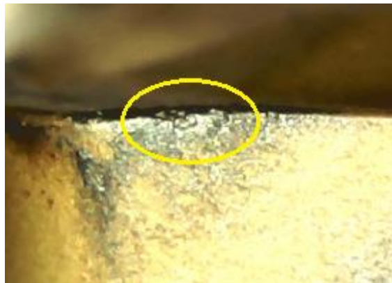
Figura 5.3 - Desgaste de Flanco para as condições A_p1 , F2 e VC1 . Fonte: Autor do estudo (2014).
