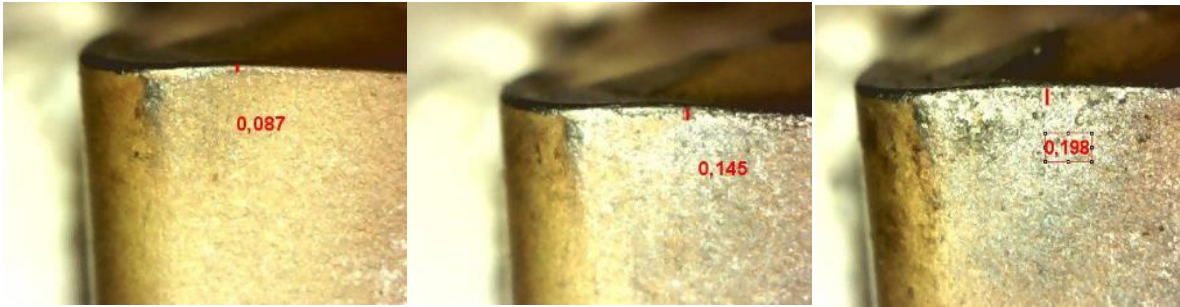
Figura 22 – Ensaio 5 - Medição do desgaste - Sequencia de desbaste (1º 2º e 3º)
