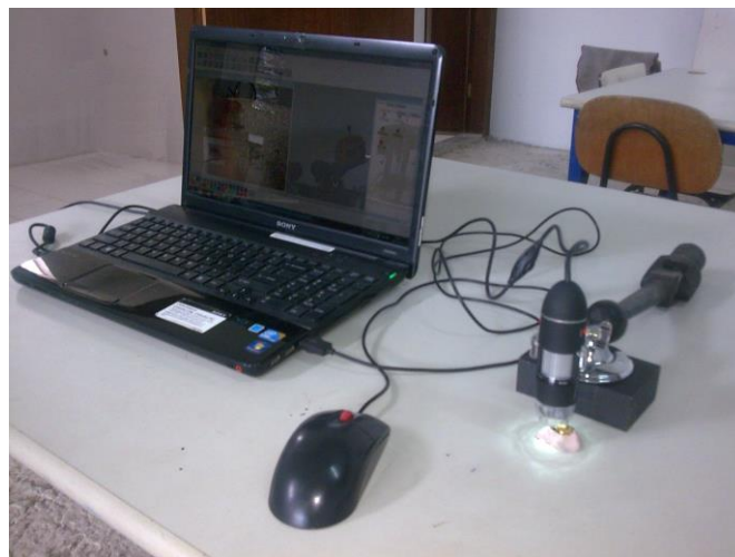
Figura 4.7 - Montagem do microscópio óptico USB. Fonte: Autor do estudo (2014).
