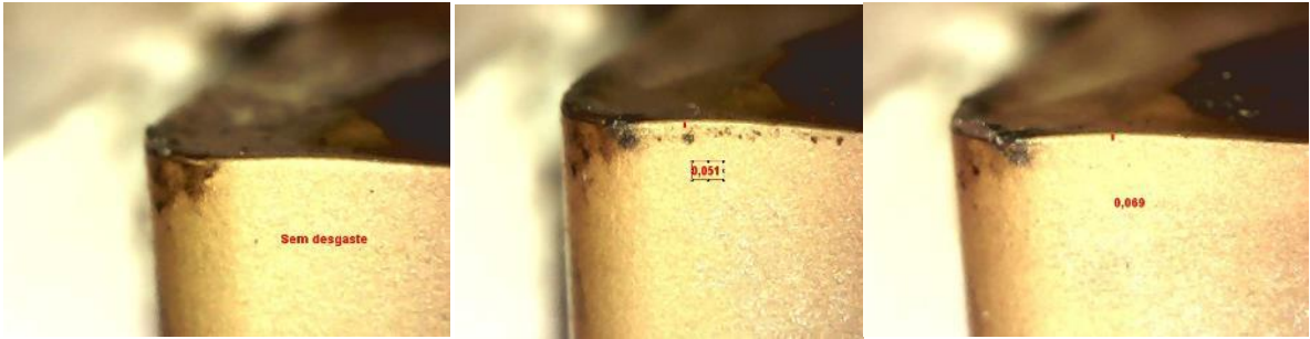
Figura 4 – Ensaio 7 - Medição do desgaste - Sequencia de desbaste (1º 2º e 3º)
