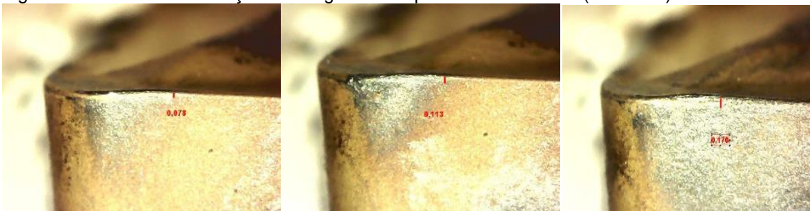
Figura 20– Ensaio 16 - Medição do desgaste - Sequencia de desbaste (1º 2º e 3º)
