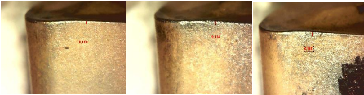
Figura 18– Ensaio 18 - Medição do desgaste - Sequencia de desbaste (1º 2º e 3º)
