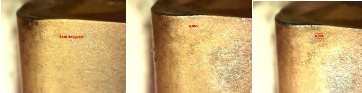
Figura 12 – Ensaio 23 - Medição do desgaste - Sequencia de desbaste (1º 2º e 3º)
