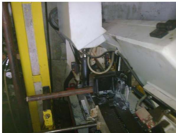
Figura 4.5 - Processo de corte na barra laminada com lubrificação Fonte: Autor do estudo (2014)
