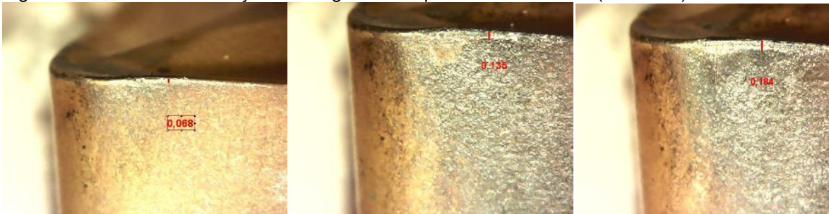
Figura 21– Ensaio 22 - Medição do desgaste - Sequencia de desbaste (1º 2º e 3º)
