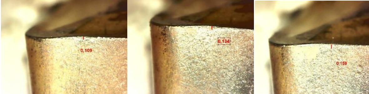
Figura 23 – Ensaio 11 - Medição do desgaste - Sequencia de desbaste (1º 2º e 3º)
