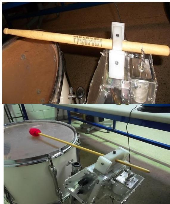
Figura 4.5: Baquetas de diferentes diâmetros inseridas no protótipo
