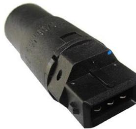
**Figura 20: Sensor de velocidade SD7063. Fonte: Próprio autor.**
