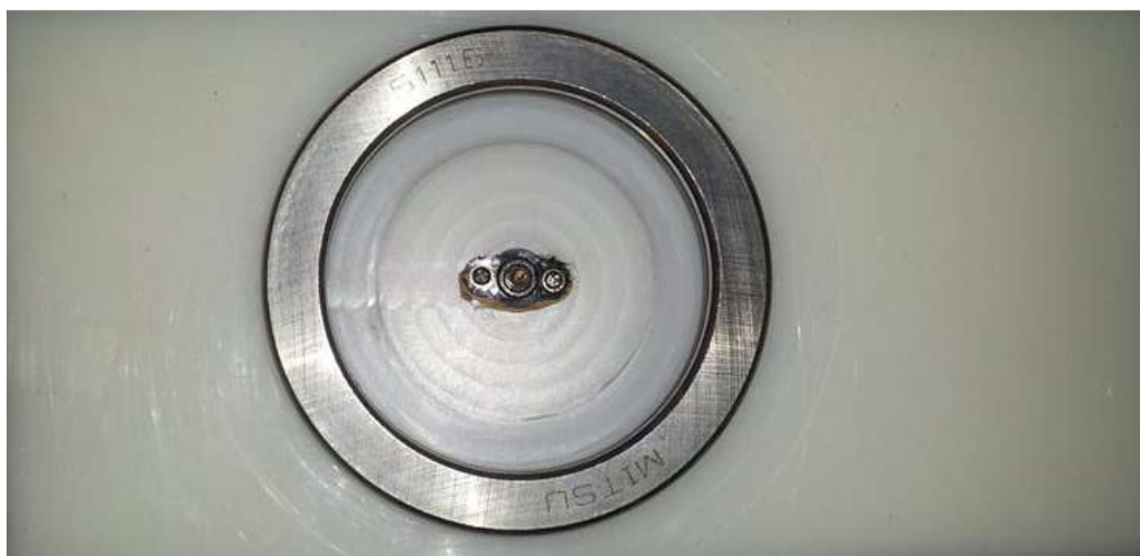
Figura 6.5: Detalhe, base de nylon e rolamento axial
