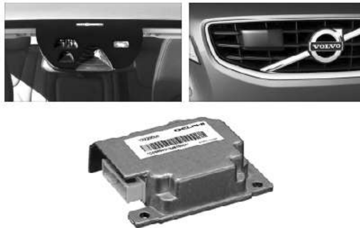
Figura 2.2: Câmera, RADAR e Unidade de Controle - CWAB-PD Volvo, Coelingh et al. [2010]
