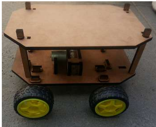
Figura 3.31: Montagem Mecânica completa - Vista lateral
