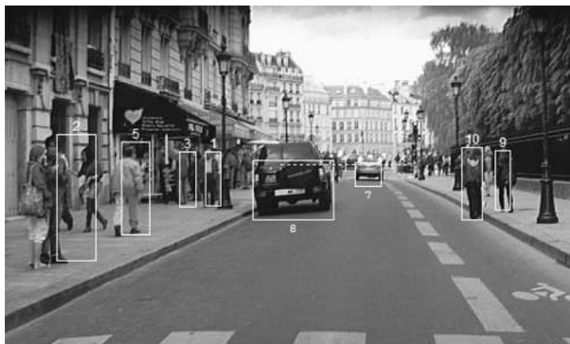
Figura 3.68: Visão sensoriamento por câmera, Sistema anticollisão Volvo, Coelingh et al. [2010]
