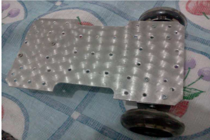
Figura 3.1 – Montagem mecânica da parte inferior do veículo (vista superior).
