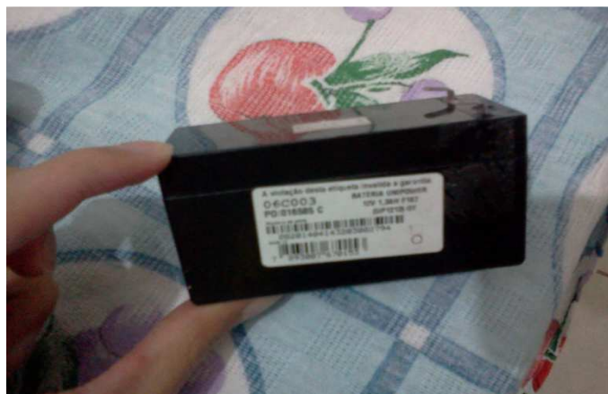
Figura 3.6 – Bateria UNIPOWER/12 V.
