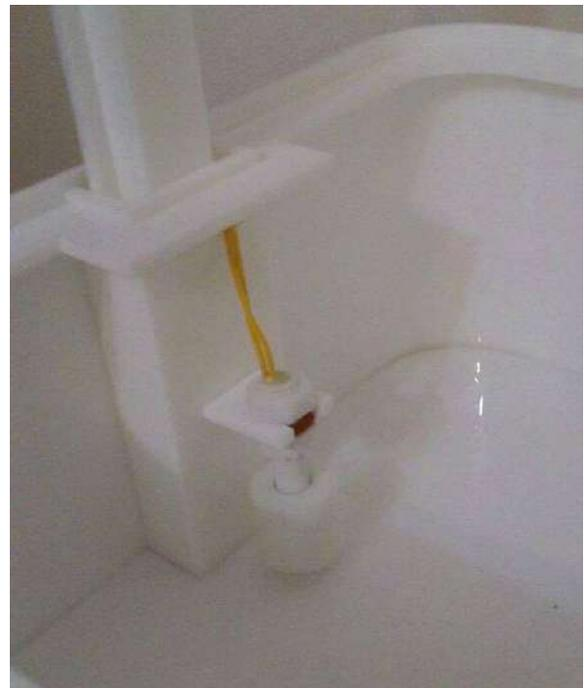
Figura 3.21 – Sensor de nível de água.
