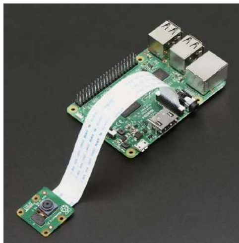
Figura 3.1: Ilustração do módulo de câmera acoplado ao Raspberry Pi 3B
