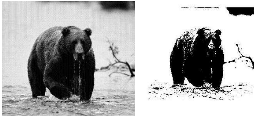
Figura 2.18: Representação da segmentação por corte, imagem original à esquerda. Imagem binarizada por segmentação à direita - Fonte: MARENGONI; STRINGHINI (2009).
