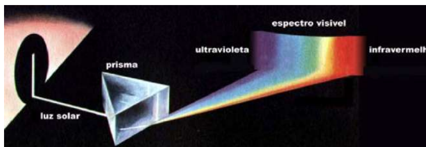
Figura 2.21: Experimento realizado por Isaac Newton para comprovar sua Teoria do prisma, que descreve que um feixe de luz branca é composto por um espectro de cores - Fonte: STEFEN (2008).
