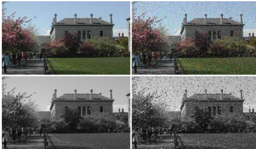
Figura 2.16: Imagens de cor (esquerda, cima) e escala de cinza (esquerda, Baixo). Estas, a direita, com 10% de ruído impulsivo - Fonte: DAWSON-HOWE (2014).
