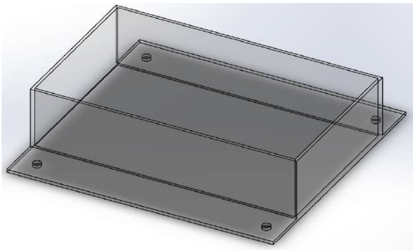
Figura 3.19: Esboço da Bacia realizado no SolidWorks.
