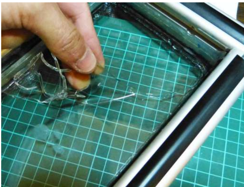
Figura 3.43: Retirada de uma camada desgastada de óleo de silicone (ILIOS3D, 2017).
