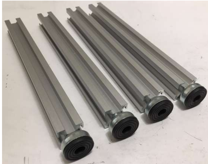
Figura 3.27: Pés niveladores instalados nas colunas da estrutura.
