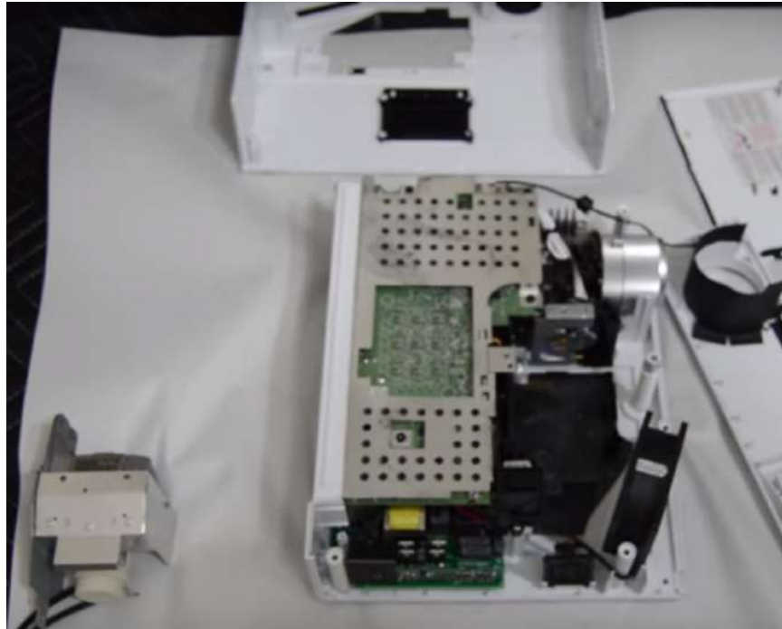
Figura 3.36: Modificação do ACER H6510BD: Retirada da lâmpada.
