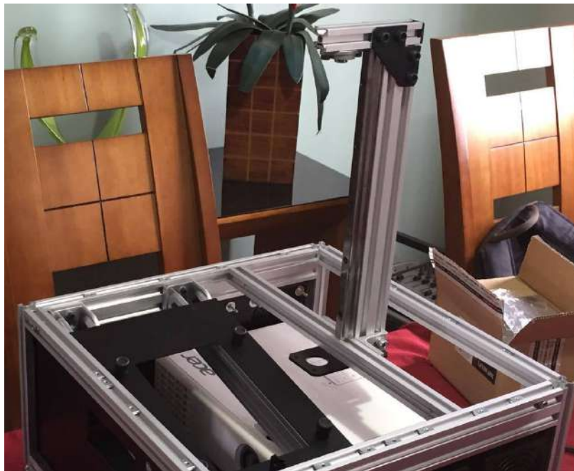
Figura 3.32: Braço e suportes dos motores instalados.
