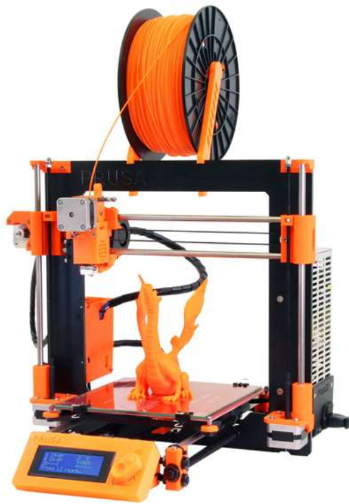
Figura 2.1: Prusa i3 MK2 - Impressora 3D de tecnologia FDM (REPRAP, 2016).
