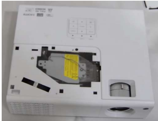
Figura 3.35: Modificação do ACER H6510BD: Retirada da tampa superior.
