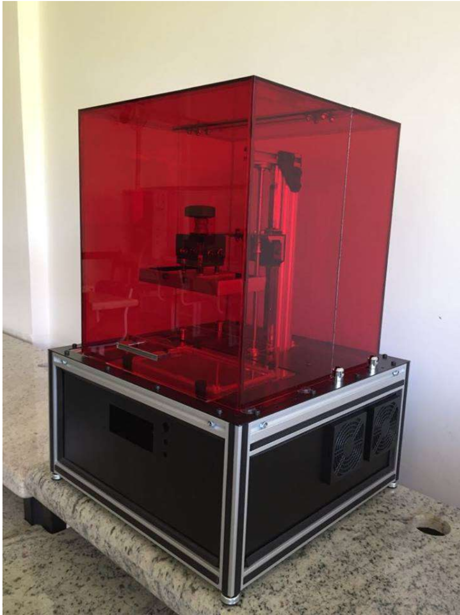
Figura 4.4: Impressora 3D DLP concluída ao final do TCC - case fechado.
